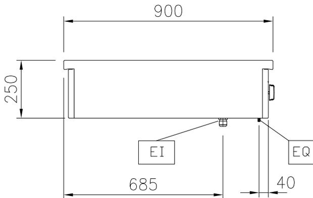
EI = Conexión eléctrica (energía)
